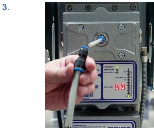
插图 74：安装柔性软管
