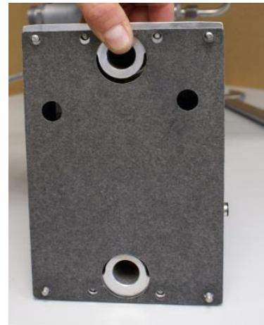
插图 107 : 放上安装板的密封件
