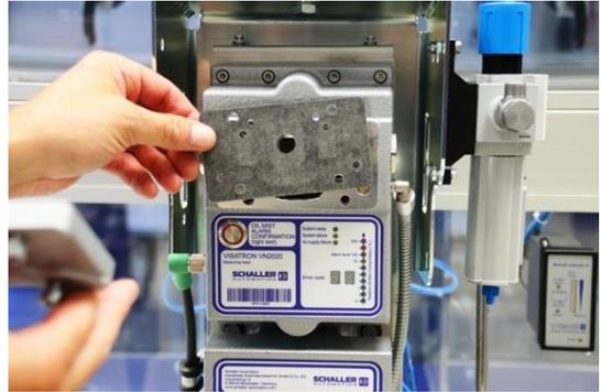
插图 64 : 拆卸密封件
