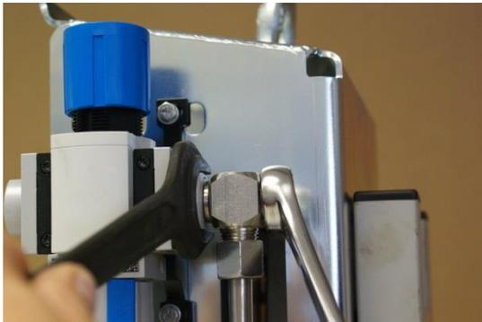
插图 132 : 拧紧摆转螺栓连接
