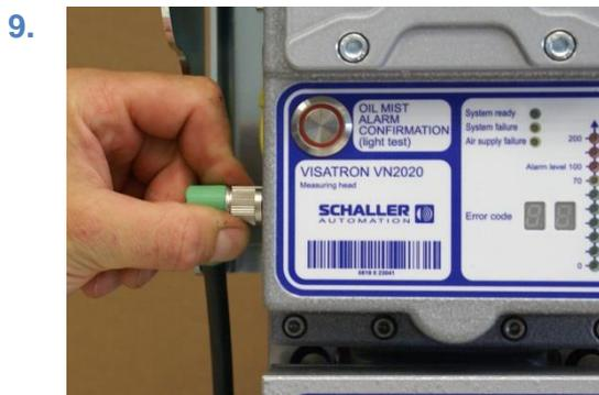
插图 110 : 安装插头连接
