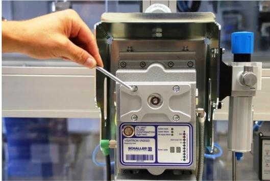
插图 63 : 拆卸螺栓
