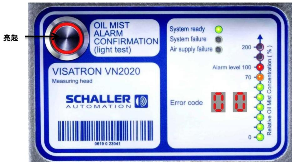
插图 61：显示屏和探测到的油雾
