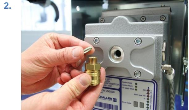
插图 55：带有快速封闭接头的检查盖
