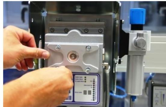
插图 147 : 安装检查盖
