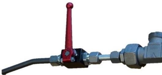
插图 128：关断压缩空气供应
