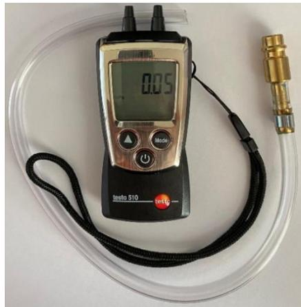
插图 172：压差测量设备
