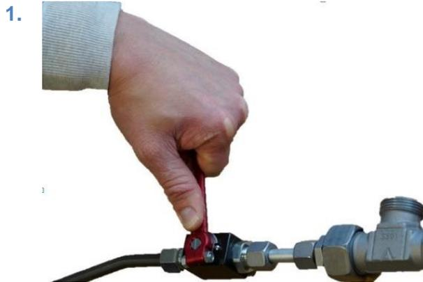
插图 137：关断压缩空气供应
