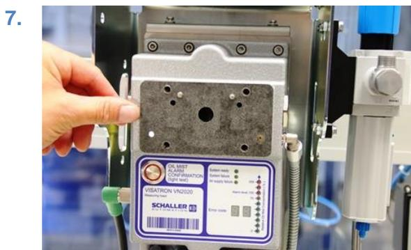
插图 69 : 新的检查盖密封件
