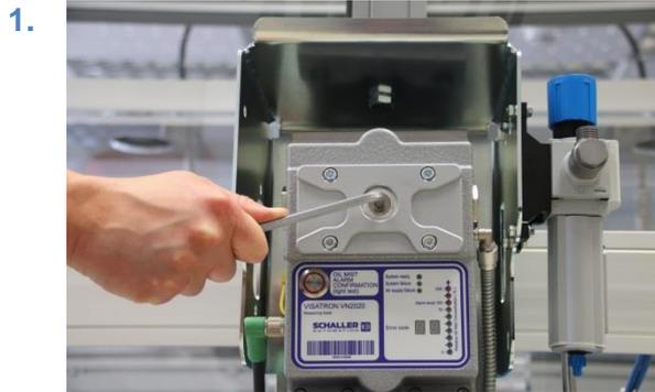
插图 54：带螺旋塞的检查盖
