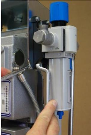
插图 130 : 拆卸过滤器调节阀
