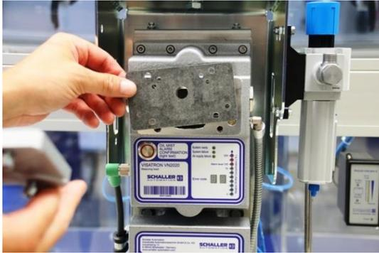
插图 144 : 取下检查盖密封件
