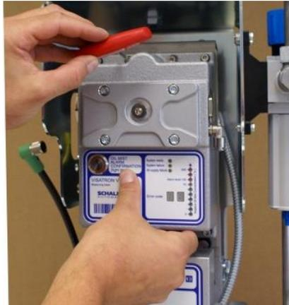
插图 157 : 安装测量附件
