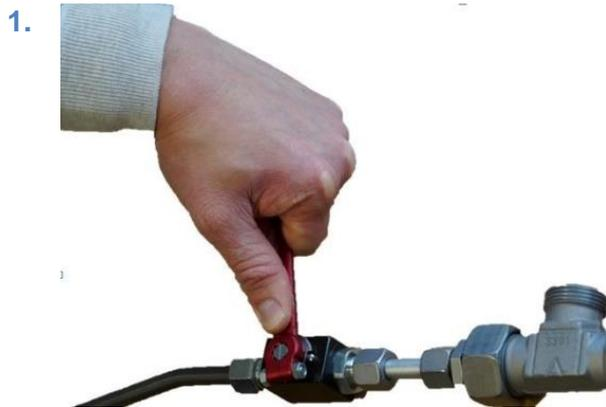
插图 142：关断压缩空气供应
