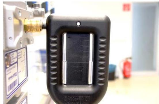
插图 149 : 检查盖上的 U 形压力计
