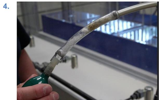
插图 75：连接烟管和泵
