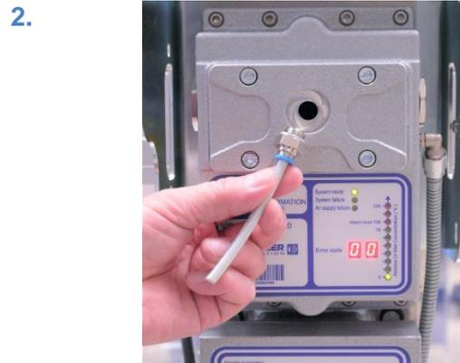
插图 73：安装适配软管
