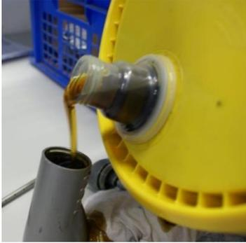
插图 31：将润滑油加注到加注泵中
