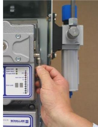
插图 160 : 安装连接软管
