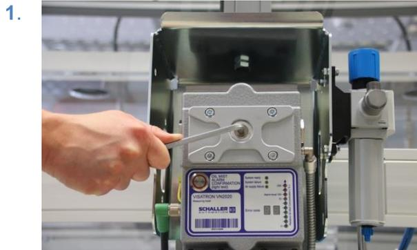
插图 72：拆卸螺旋塞
