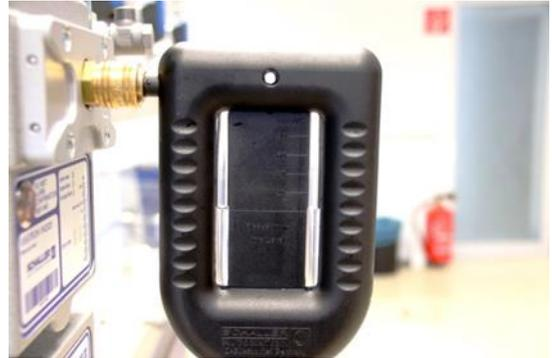
插图 162 : U 形管压力计
