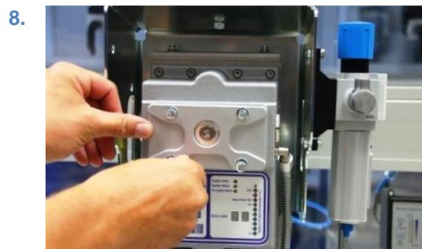
插图 70 : 安装检查盖
