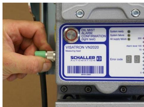
插图 120 : 安装插头连接器
