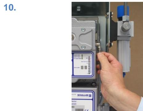
插图 111 : 安装连接软管
