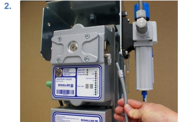
插图 138：拆卸连接软管
