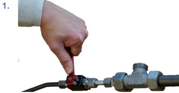
插图 90 : 关闭压缩空气
