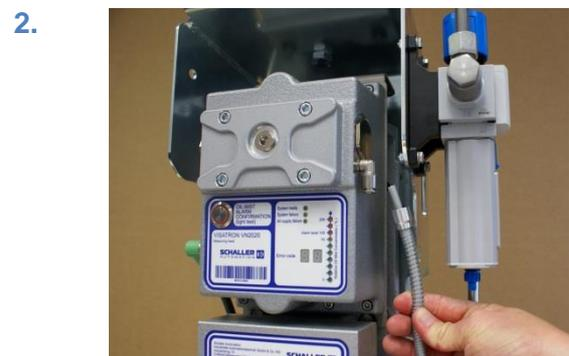
插图 103 : 拆卸连接软管
