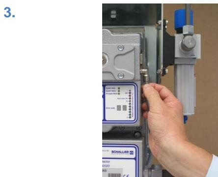
插图 139：安装连接软管
