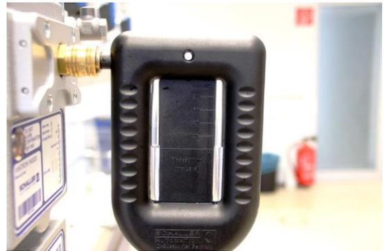
插图 59 : U 形管压力计上负压的显示
