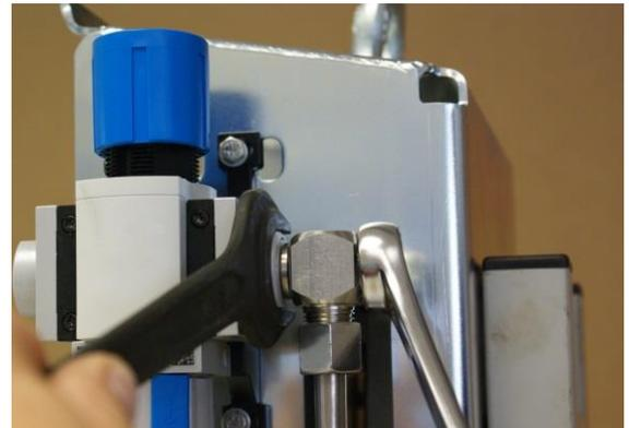
插图 129：拆卸摆转螺栓连接
