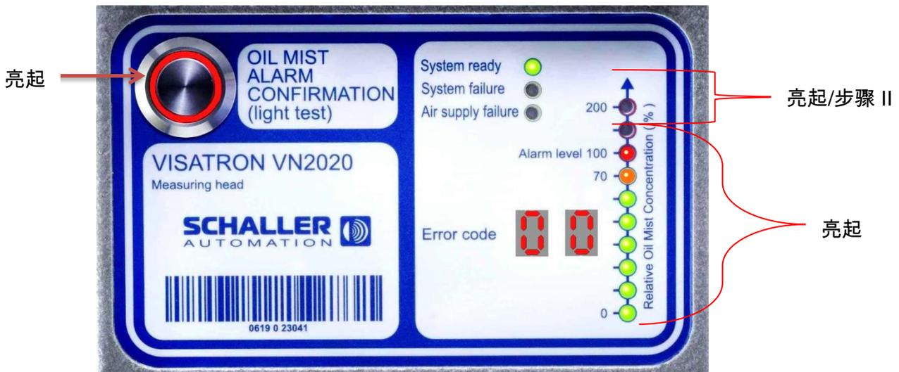
插图 62：带有报警的 LED 显示屏示例显示
